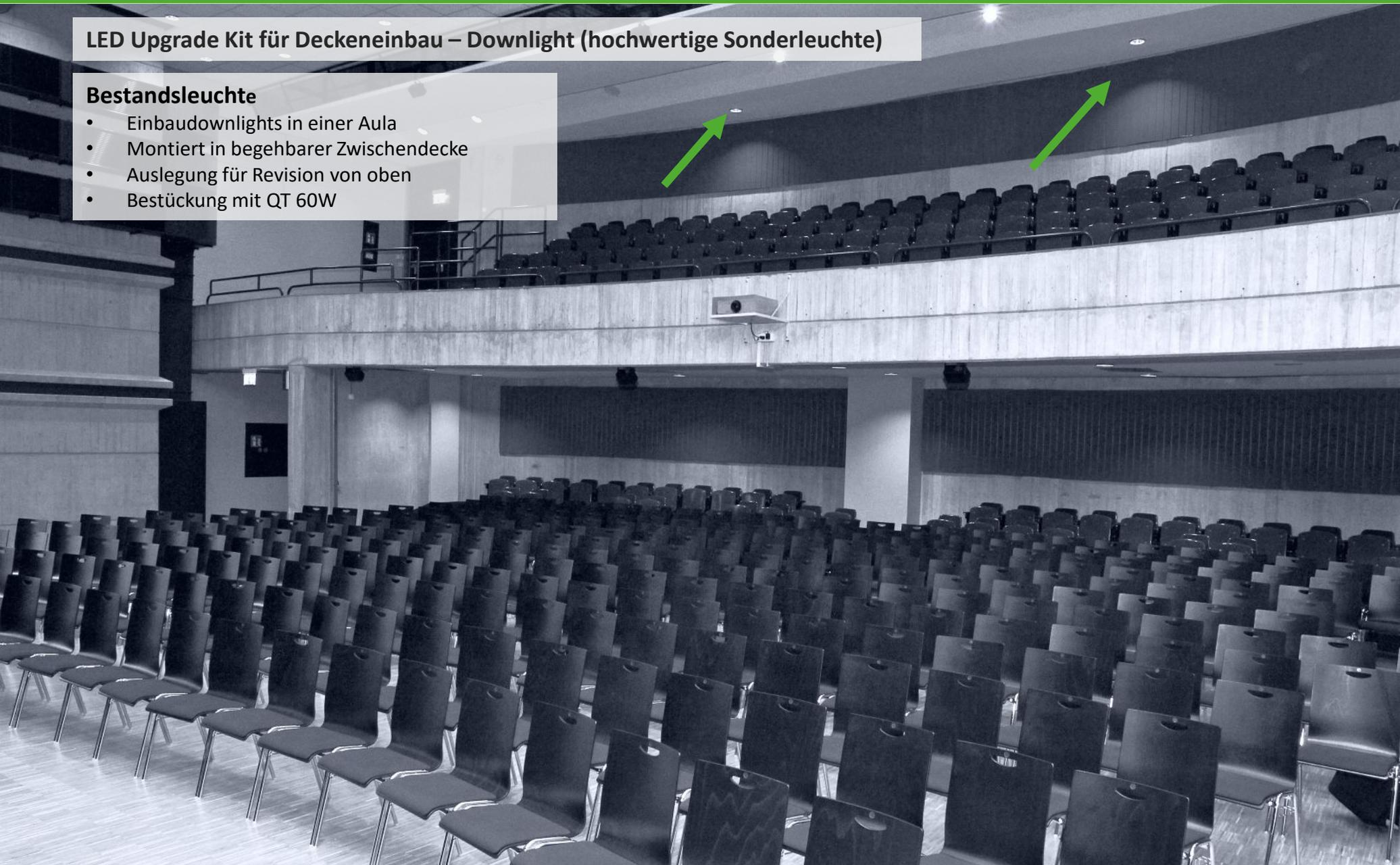
LED Upgrade Kit für Deckeneinbau – Downlight (hochwertige Sonderleuchte)
