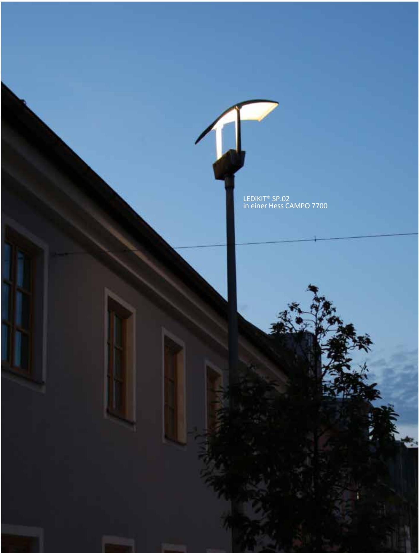
Bei LEDiKIT® Streetlight SP2 handelt es sich um eine Baugruppe welche im Austausch gegen die vorhandenen Einbauten in die jeweiligen Leuchtgehäuse montiert wird. Nach außen erscheinen die jeweiligen Bestandsleuchten daher unverändert.
