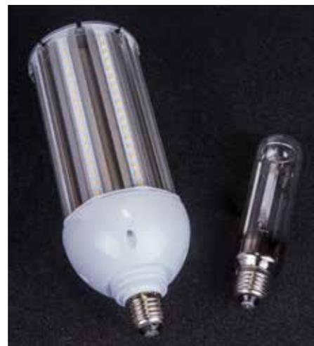
Maiskolbenlampe (54W / 6.000lm) als (vermeintlicher) Ersatz für eine Natriumdampflampe 70W / 6.600lm im direkten Größenvergleich
