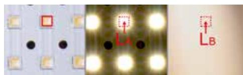
Lichtpunkte frei abstrahlender LEDs weisen Leuchtdichten  $> 10^6 \text{ cd/m}^2$  auf ( $L_1$ ) und übersteigen die von diffusen Lichtaustrittsflächen ( $L_2$ ) um Größenordnungen
