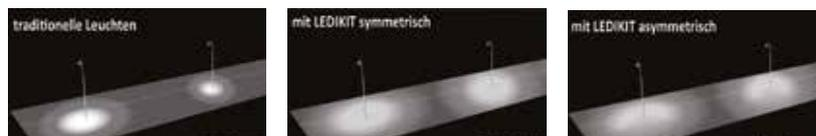
Für die Erzielung einer möglichst gleichmäßigen Beleuchtungsstärkeverteilung auf der Nutzfläche, sowie das „Auffüllen“ von Dunkelzonen im Mittenbereich zwischen zwei Lichtmasten, haben wir dezidierte Lichtlenkungssysteme entwickelt. Ein Zusammenspiel aus exakt berechneten Reflektoren und Refraktoren sorgt für eine optimierte Lichtverteilungscharakteristik der Ledikits. Gleichzeitig gelingt es die Blendwirkung auf ein komfortables Maß zu begrenzen.
